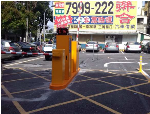
圖十一 自動柵欄機進出場管制
