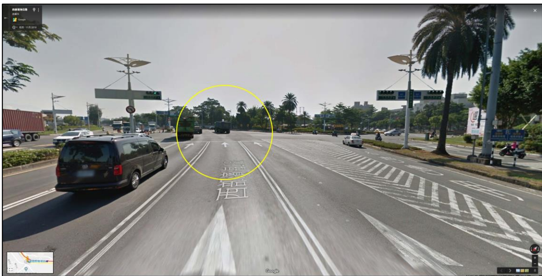
圖 6.1-3 路幅較寬不適用一近一遠燈面之情形 (黃圈為駕駛視野 20 度清楚的範圍)
