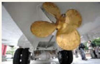
▲ 鴨子船四葉式推進器，適用車輪、渡輪。
